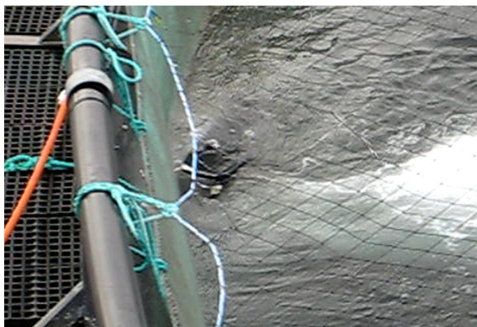
Figur 6: Strøm og bølger kan dytte vaskeutstyret vekk fra nota.
