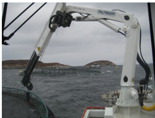
Figur 4: Ukontrollert bruk av kraftig løfteutstyr kan føre til store skader på not.
